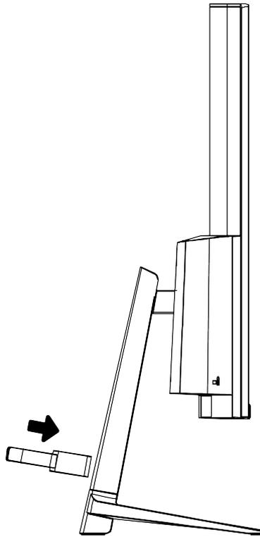
**Monte o organizador de cabos ao concluir a instalação, instale o organizador na parte inferior do pedestal.**
