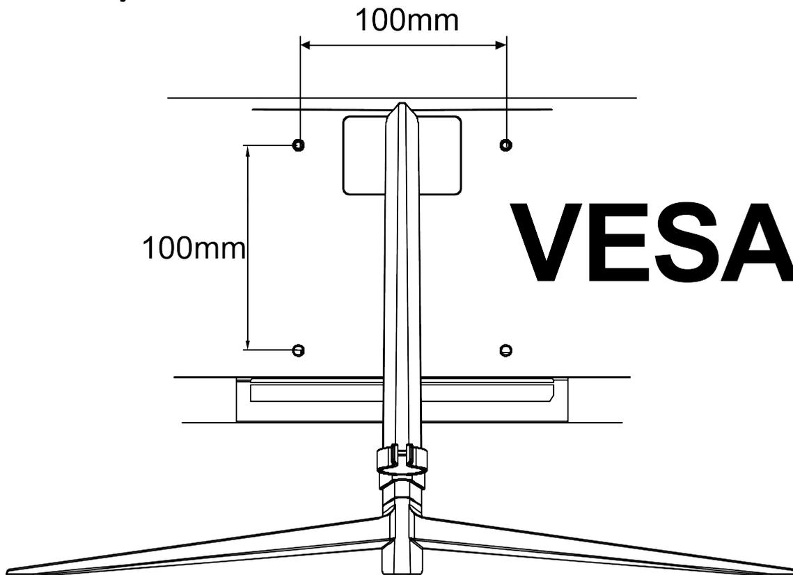
Para realizar a montagem VESA será necessário utilizar 04 parafusos M4x20mm, cada um deverá ser instalado de acordo com o desenho da figura acima.
