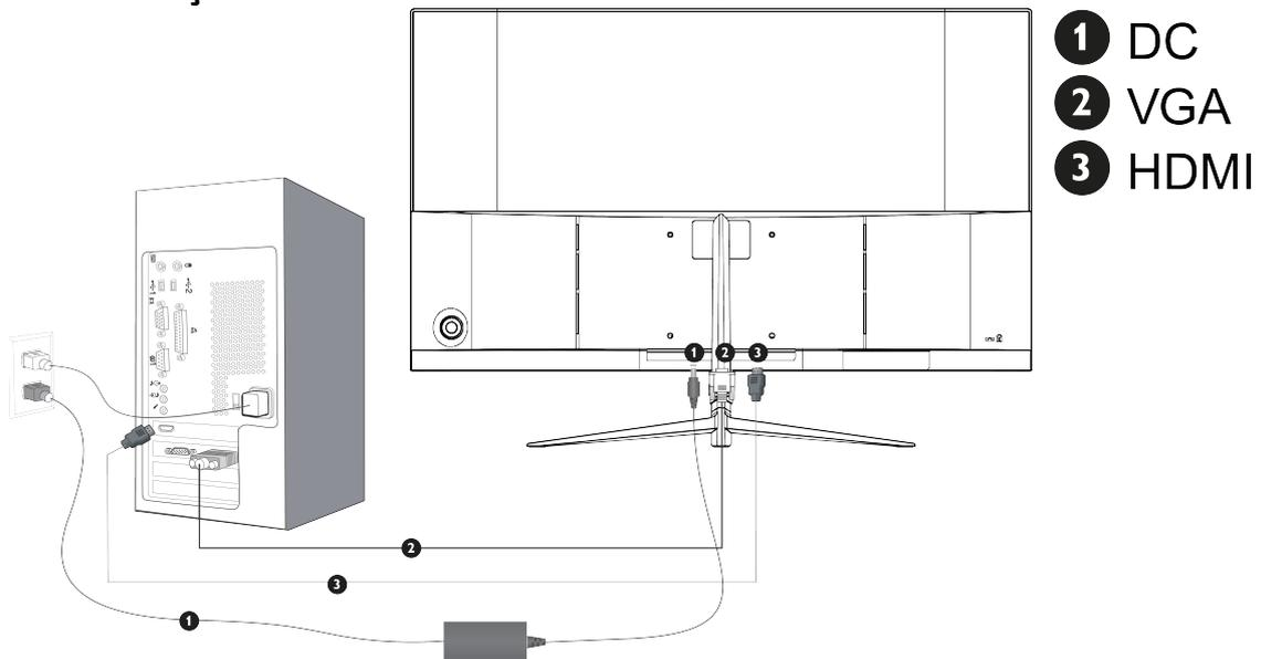
1. Conecte a fonte externa ao conector DC (Item 1), esta deverá ser conectada a uma tomada AC que poderá ser 110 V ou 220 V.
