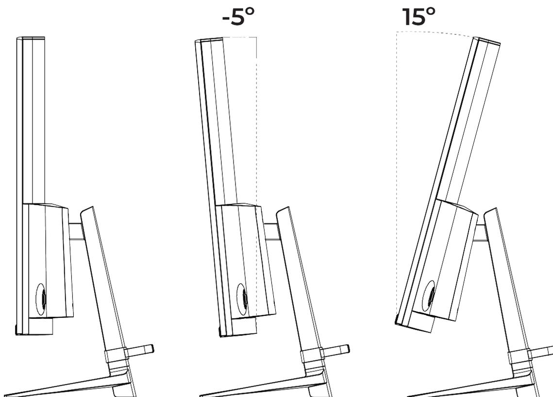
É possível ajustar o monitor BM27FFH3GC ou BM27FFH3GCW para uma leve inclinação para trás de até 15° ou para uma leve inclinação para frente de até 5°.
