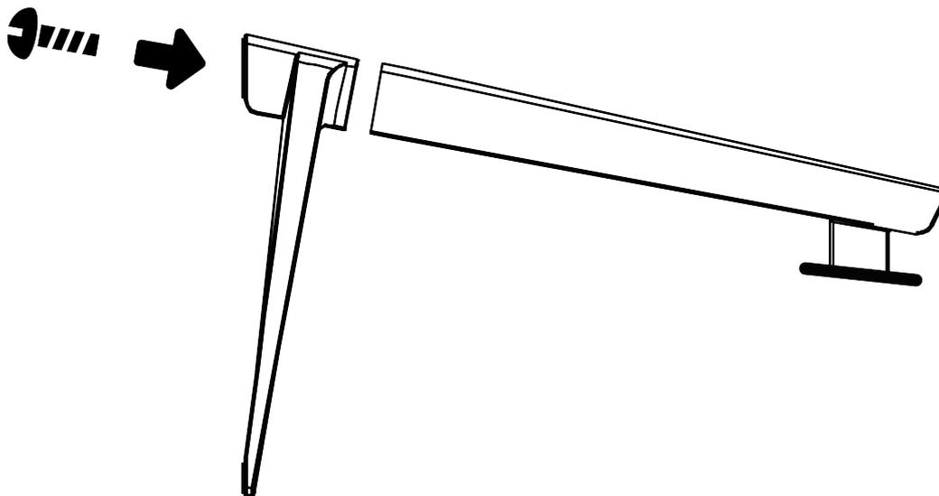
*Retire a base e a coluna do pedestal da embalagem, monte a base utilizando um parafuso do kit de parafusos conforme indicado na figura a esquerda.*
