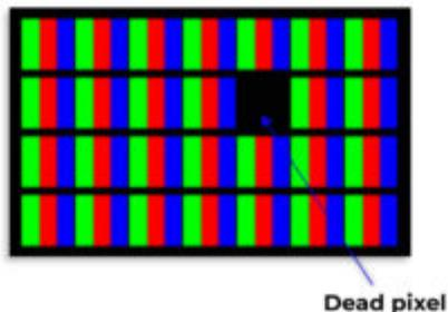
**Dead/Dark pixel:** Quando todos os três sub-pixels estão danificados, o pixel em estado permanentemente desligado e apresenta um ponto preto na imagem em qualquer tipo de imagem.
