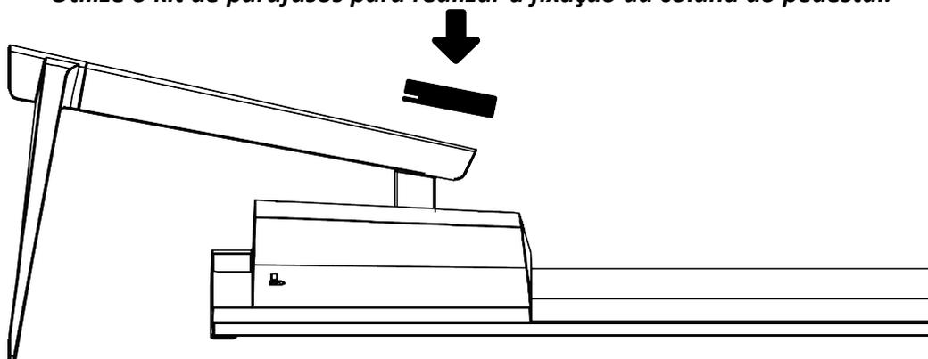
*Em seguida utilize a tampa do acabamento traseiro para finalizar a montagem.*
